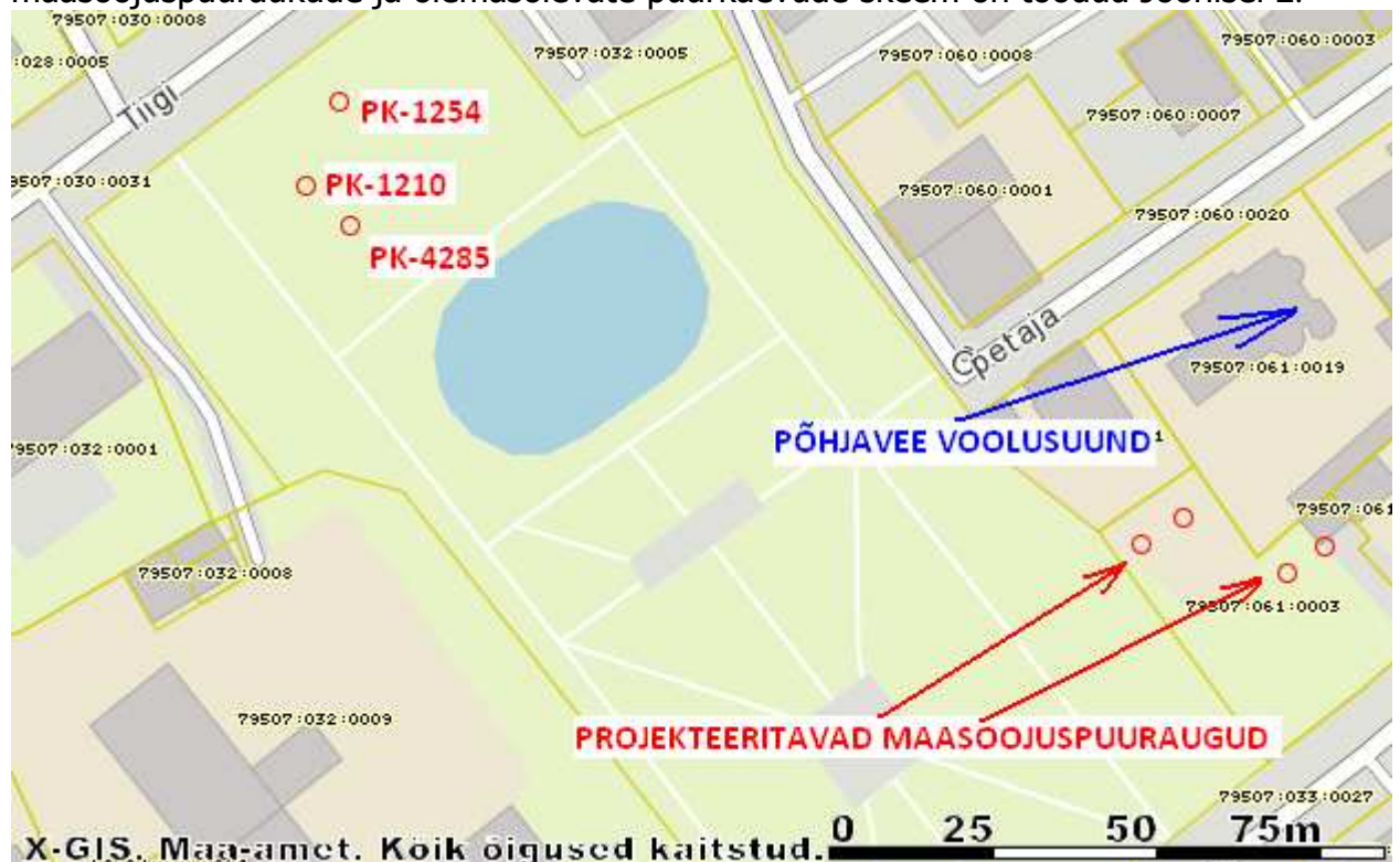
Joonis 2. Projekteeritavate maasoojuspuuraukude ja olemasolevate puurkaevude skeem
